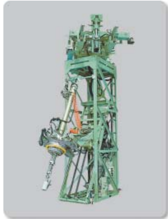
自動スライドランス Automatic Telescopic Lance
