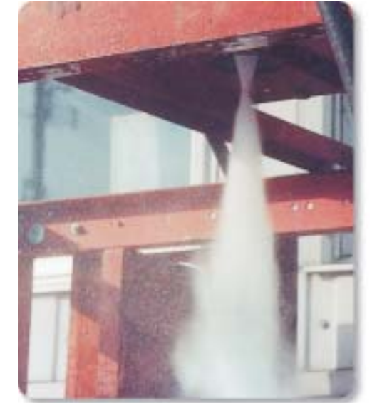
水アトマイズ Water Atomization
