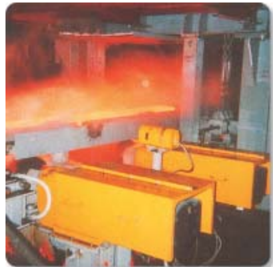
圧延工程のデスケーリング Descaling in the Process of Rolling Mill
